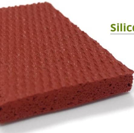
Material con gran capacidad de recuperación. Diseñada para su aplicación en máquinas de termosellado, cierres automatizados de bolsas y packaging plástico. Con una cara en acabado impresión fuerte y otra lisa o impresión fina. Disponible en plancha y tiras de diversas secciones, también con adhesivo. Colores rojo/marrón y negro.
